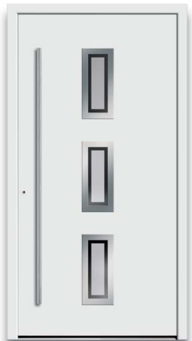
Modell 7745-70 | Rahmen-Edelstahloptik Glas: G 500-25 mattiertes Glas mit klarem Rand | Aufsatzfüllung | Mit 1600 mm Edelstahl-Stangengriff
